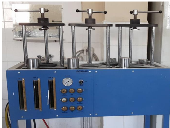
Şekil 3.7. Deneylerde kullanılan basınçlı su geçirirliiği cihazı
