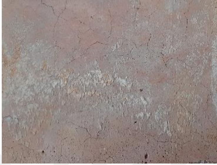
Şekil 4.4. 600°C’de 10KÇ numunesinde görülen renk değişimi
