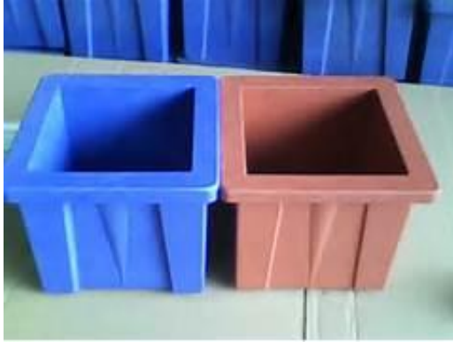
Şekil 3.3. Beton numunelerini üretmek için küp ve silindir kalıplar
