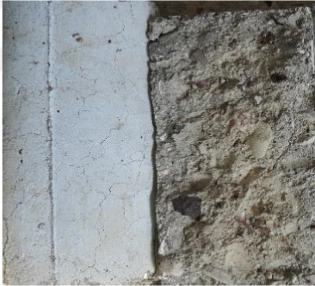
Şekil 4.5. 800°C de 15KÇ numunesinde kırık yüzeyi görüntüsü
