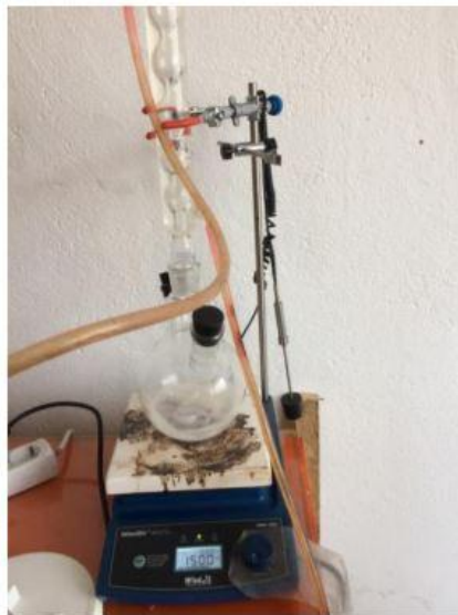
Resim 5.2 Alkol ve katalizörün manyetik ısıtıcı ile ısıtılması.
