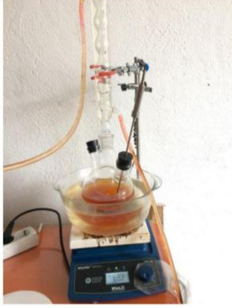
Resim 5.3 Manyetik ısıtıcıda atık kızartma yağının ve metoksitin karıştırılması.
