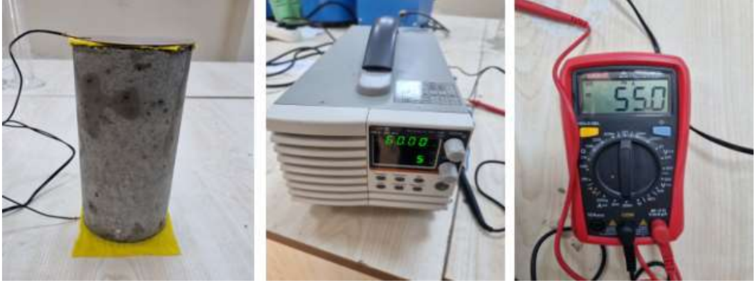
Şekil 3.13. Elektriksel özdirenç ölçümünde kullanılan ekipmanlar ve düzenek
