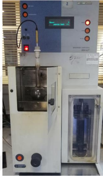
Şekil 4.3. Herzog HDA 627 Atmosferik Destilasyon Cihazı
