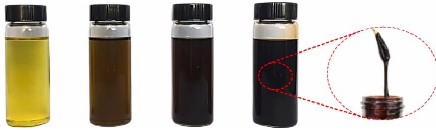
Şekil 5.2. TPO Fraksiyonlarının Soldan Sağa Doğru: Hafif, Düşük-Orta, Yüksek-Orta, Ağır Görünüşleri
