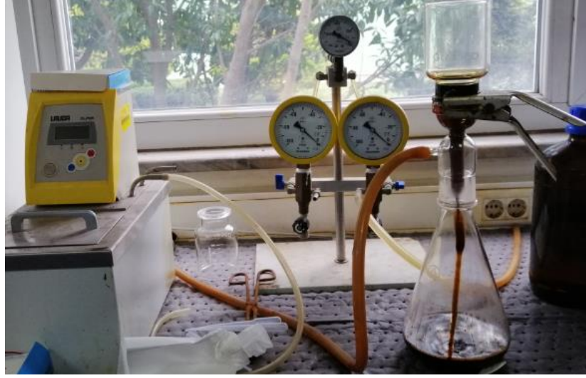
Şekil 4.6. Seta Vakum ve Süzme Aparatı
