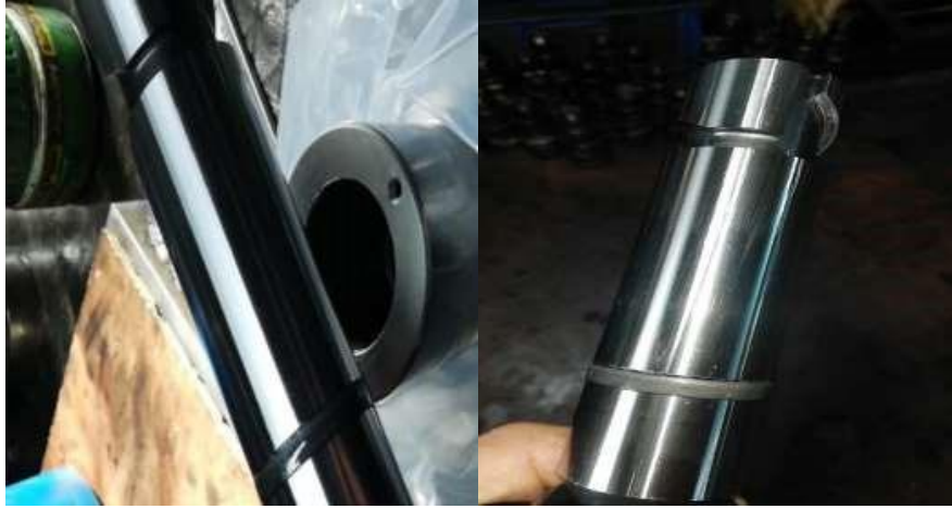
Şekil 5.13. Yüksek Basıncılı Yakıt Pompası Planceri a)Yeni Plancer b) Kullanılmış Plancer
