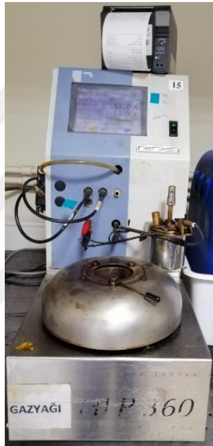
Şekil 4.9. Herzog HFP 360 Flash Point Cihazı
