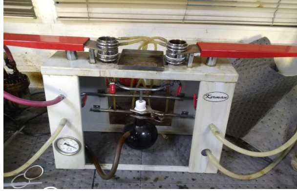
Şekil 4.14. Toplam Tortu Tayini Aparatı
