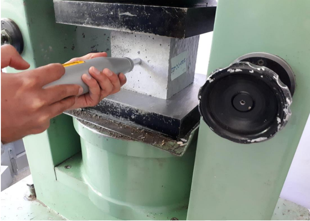
Şekil 3.8. Betonun geri sıçrama değerinin tayini deneyi
