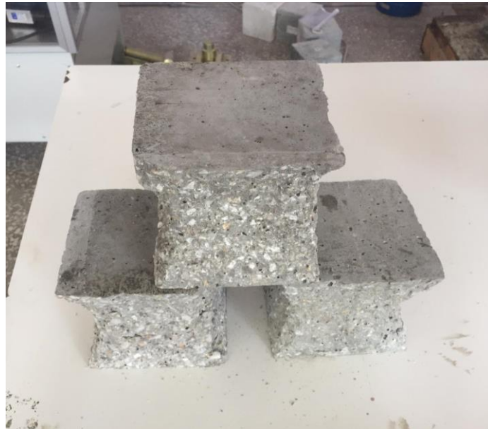
Şekil 3.10. Basınç dayanımı deneyi, numune kırılma şekilleri
