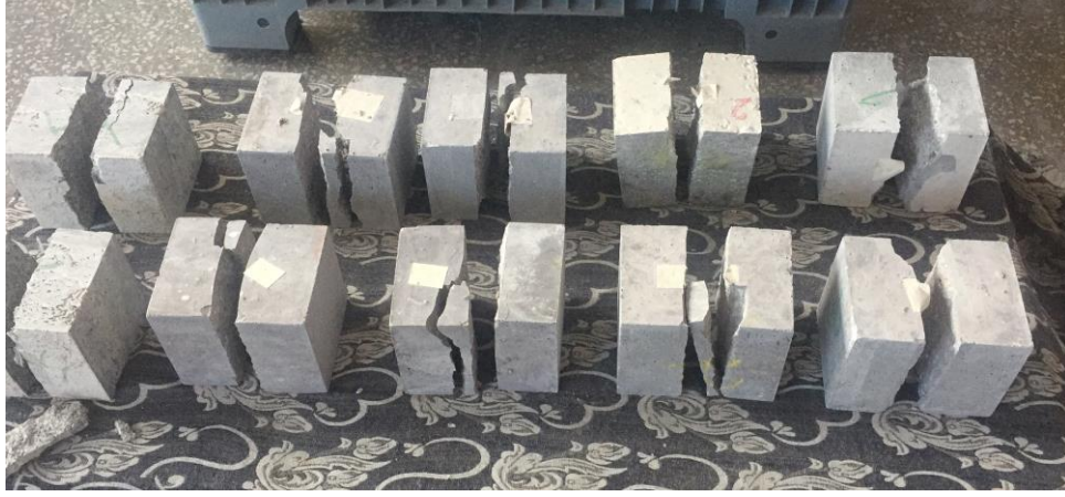
Şekil 3.11. Yarmada çekme dayanımı deney düzeneği
