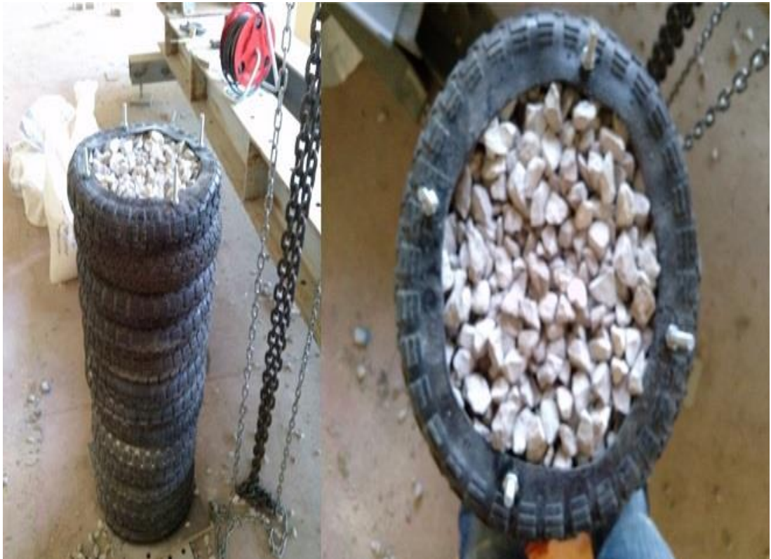
Şekil 5.3: Lastik malzemesi içine yerleştirilen çakıl.
