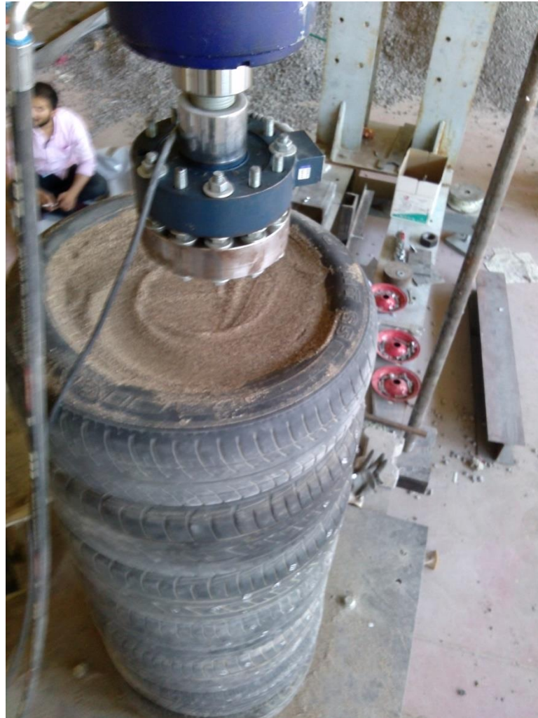
Şekil 5.16: Lastik sarmallı kum kolon (3. Aşama).
