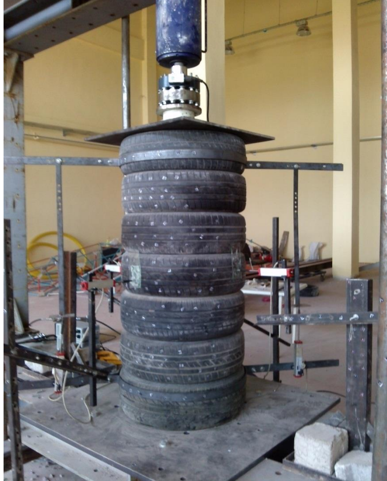
Şekil 5.10: Lastik sarmallı taş kolon (2. Aşama).
