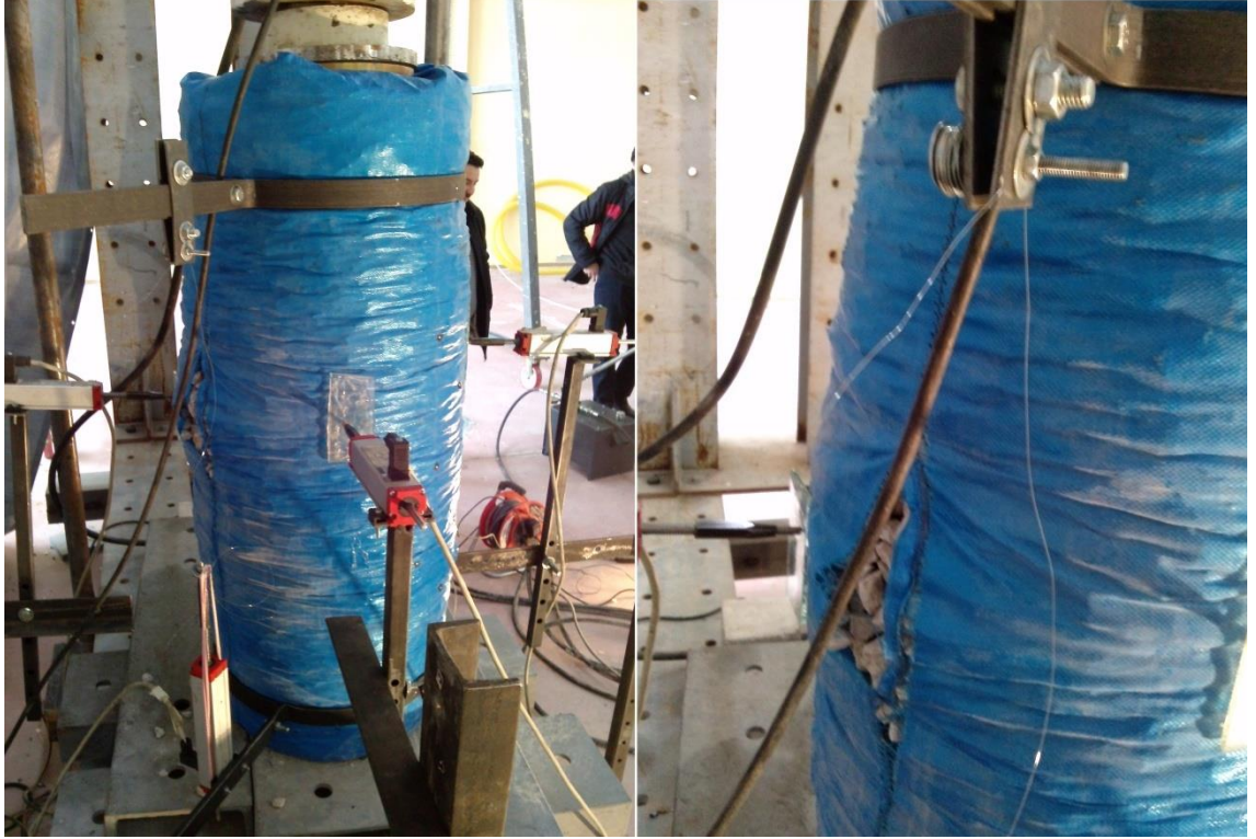
Şekil 5.7: Polyester sarmallı taş kolon (1. Aşama) göçme anı.
