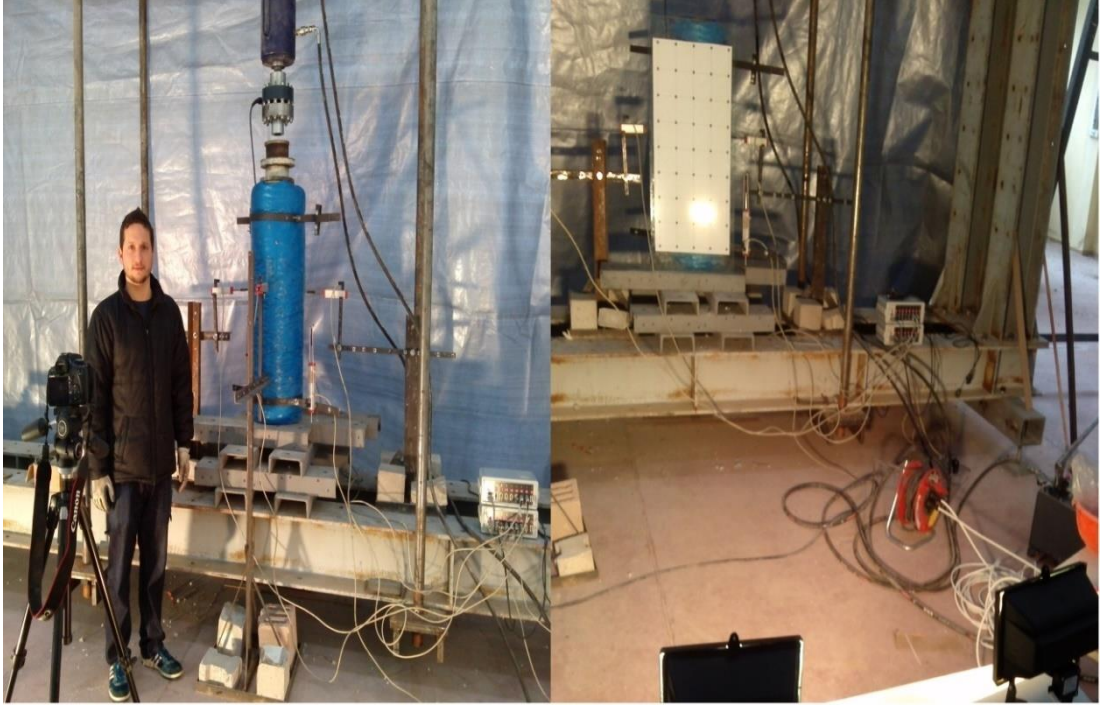
Şekil 5.4: Polyester sarmallı taş kolon (1.Aşama).
