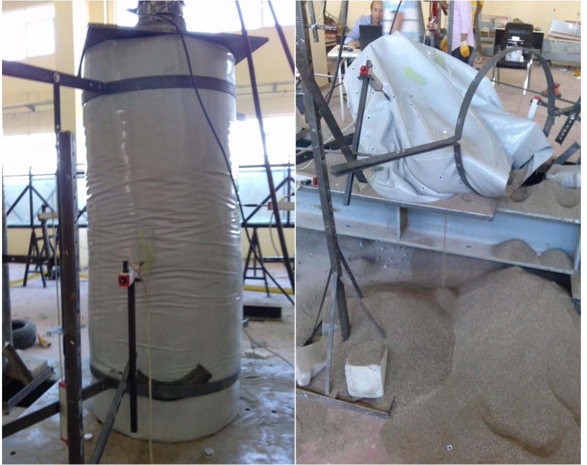
Şekil 5.19: Polyester sarmallı kum kolon (3. Aşama).
