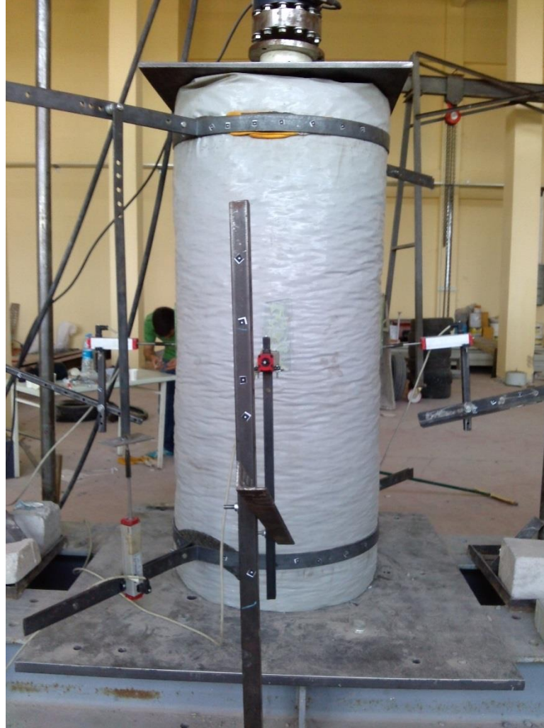
Şekil 5.11: Polyester sarmallı taş kolon (2. Aşama).
