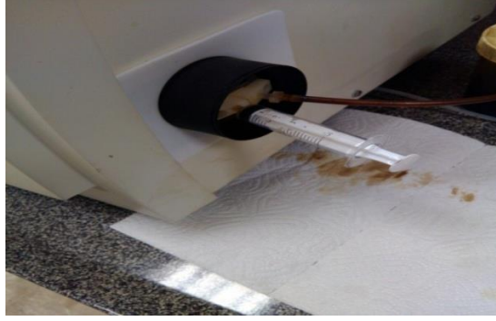
Resim 3.2 Numunenin cihaza enjekte edilmesi.
