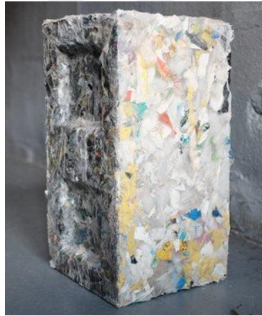
Şekil 2.69. Plastik atıklardan üretilmiş plastik blok (URL-84)
