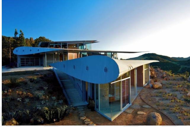
Şekil 2.91. Uçak gövdesinin çatı kaplaması olarak kullanım örneği (URL-112)
