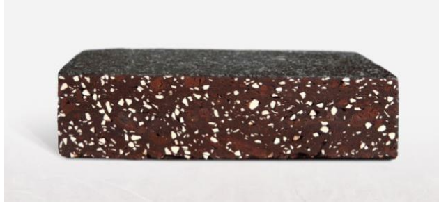
Şekil 2.44. Endüstriyel atıklardan üretilmiş wastebasedbrick (URL-58)
