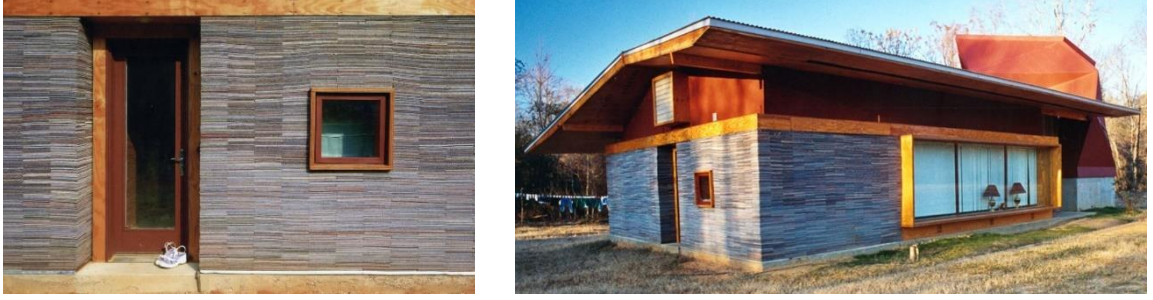
Şekil 2.70. Halı duvarın konut ölçeğinde uygulanması (URL-85)
