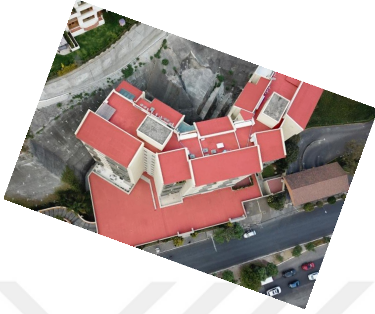
Şekil 2.83. Imperllanta su yalıtım uygulaması örneği (URL-105)
