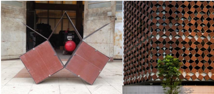
Şekil 2.57. Geri dönüştürülmüş seramik tuğla ve uygulama örneği (URL-72)
