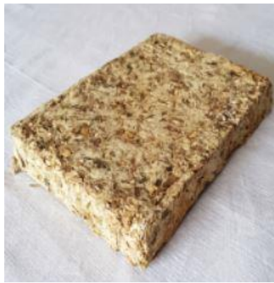
Şekil 2.86. Anızdan üretilen yalıtım malzemesi örneği (Savio ve diğ., 2022)
