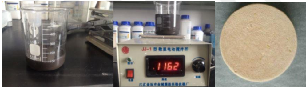
Şekil 2.51. Atık cam ve uçucu külden üretilen ısı yalıtım malzemesi (Zhang ve diğ., 2014)
