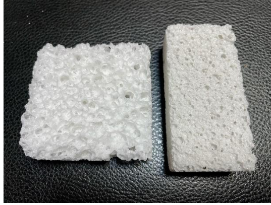
Şekil 2.50. Atık camlardan üretilmiş cam köpüğü örneği (URL-64)
