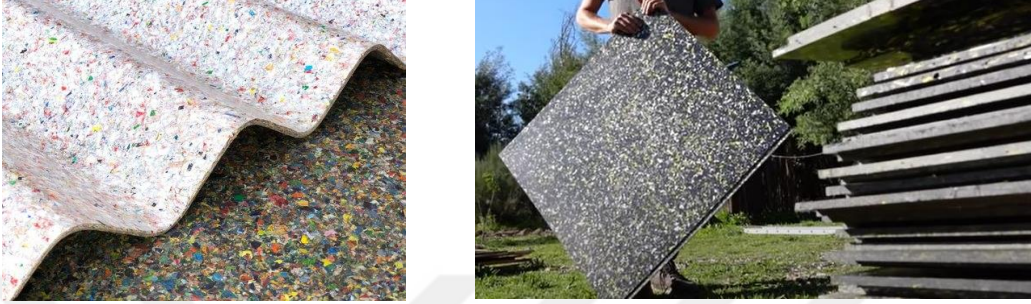
Şekil 2.89. Evsel plastik atıklardan çatı kaplaması; solda oluklu formda sağda düz formda (URL-111)
