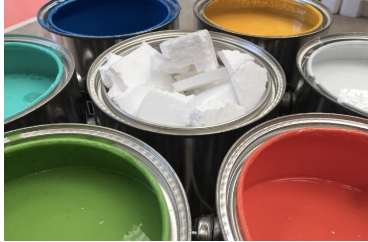
Şekil 2.66. Geri dönüştürülmüş EPS' den boya yapımı (URL-81)
