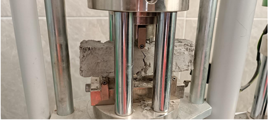
Şekil 3.8. Eğilme deneyinden bir görüntü
