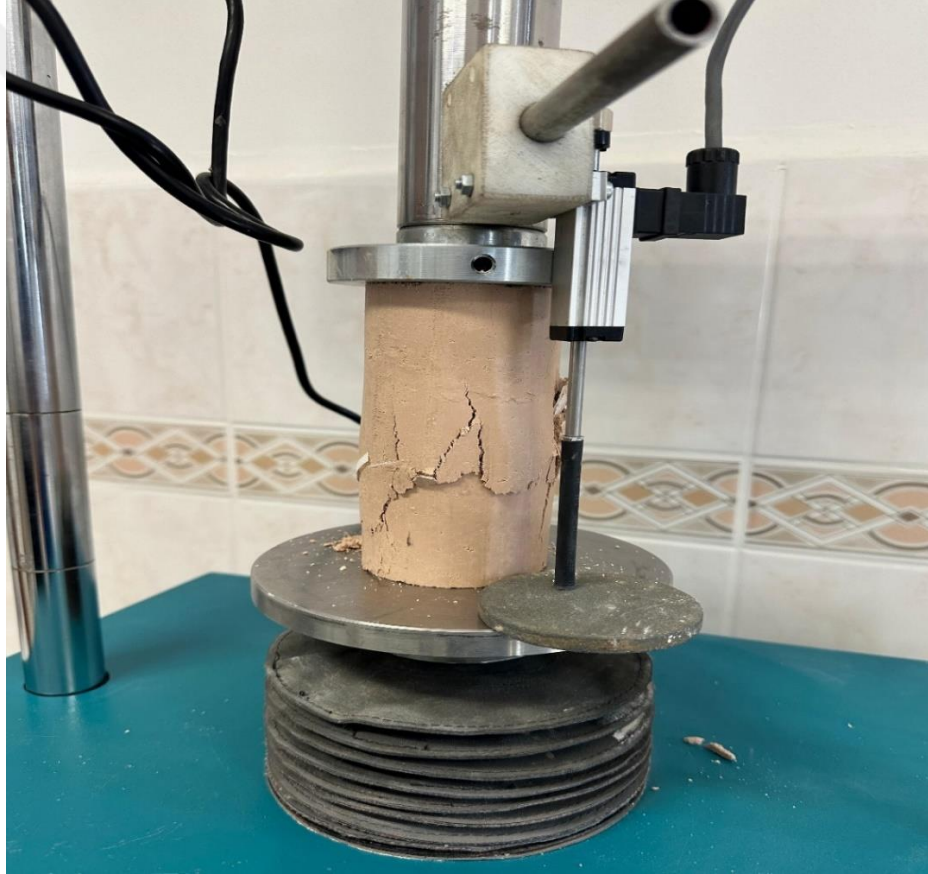
Şekil 4. 13. Serbest basınç deneyinde Yük dayanım Belirlenmesi
