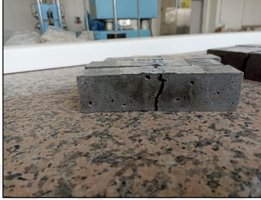
Görsel 5.1. Eğilme deneyi sonrası kırılan numune
