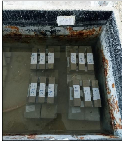
Görsel 4.6. Numunelerin kür havuzunda bekletilmesi
