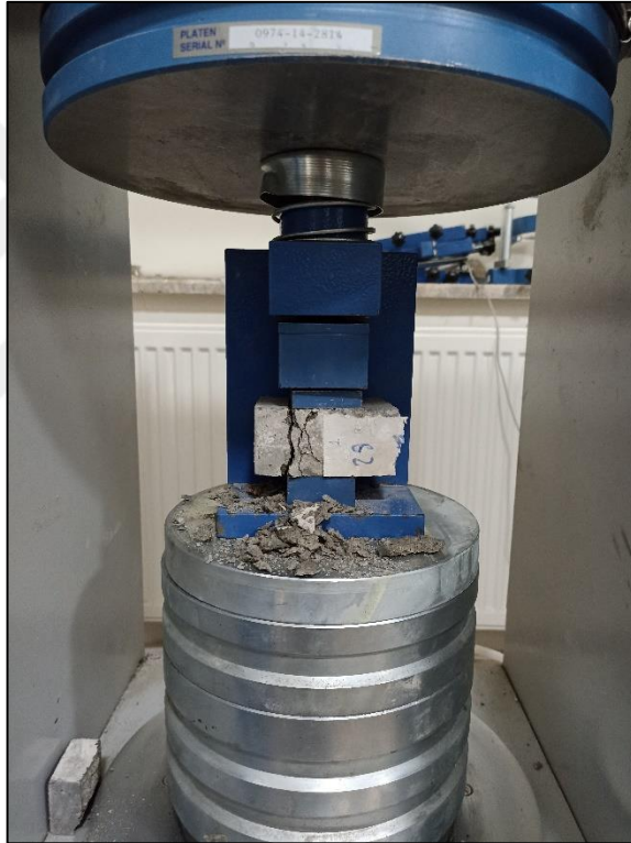
Görsel 5.2. Basınç deneyi sonrası kırılan numune
