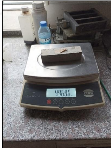
Görsel 4.8. Etüv kuru su numunenin tartımı
