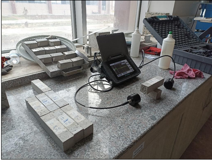
Görsel 4.9. Ultrasen geçiş hızı deneyi
