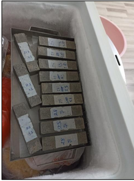
Görsel 4.7. Donma-Çözülme uygulaması
