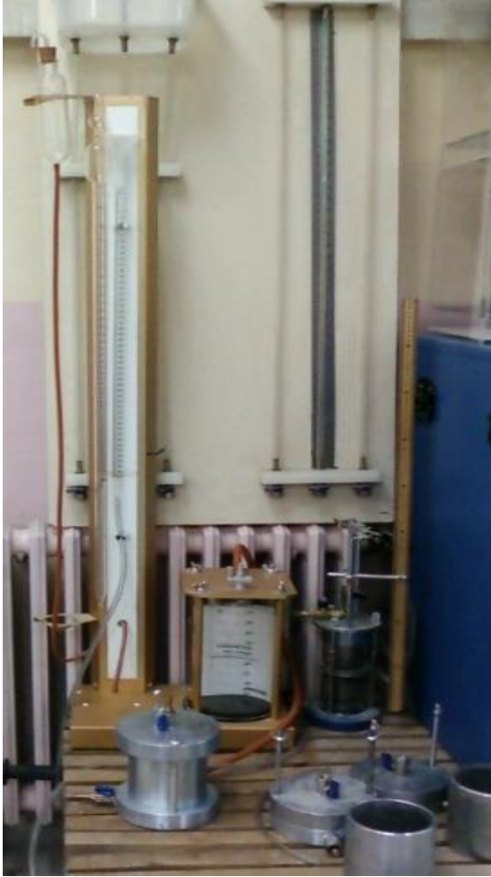
Şekil 4.6 Düşen seviyeli permeabilite düzeneği ve sıkıştırma kalıpları.
