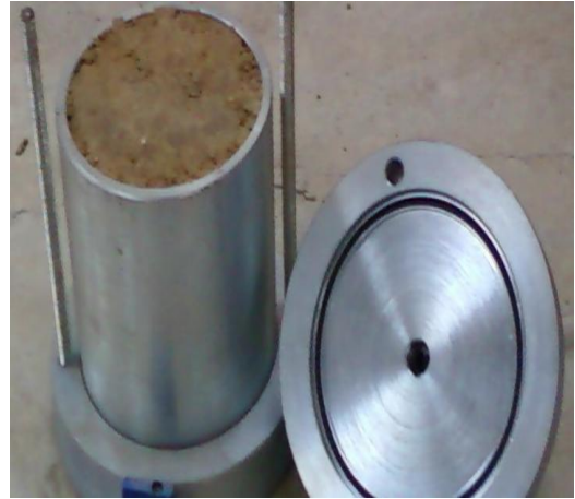
Şekil 4.6 Düşen seviyeli permeabilite düzeneği ve sıkıştırma kalıpları.
