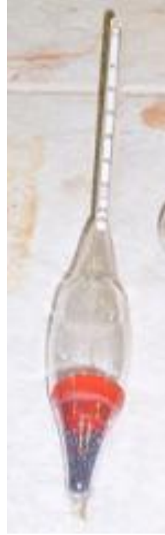
Şekil 4.1 24 saat sonunda hidrometre mezürü içinde çökelen tanelerin üstte ince altta kalın tabaka oluşturması.
