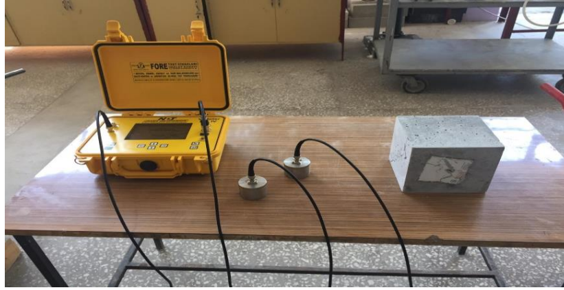
Şekil 3.11. Ultrases geçiş hızı görüntüsü
