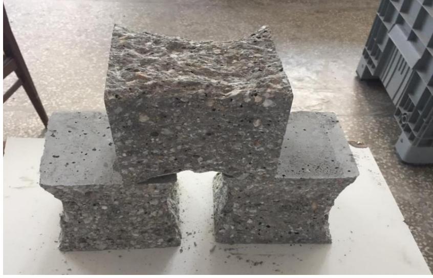
Şekil 3.13. Üretilen çevre dostu betonun basınç testi altında numune görünümü
