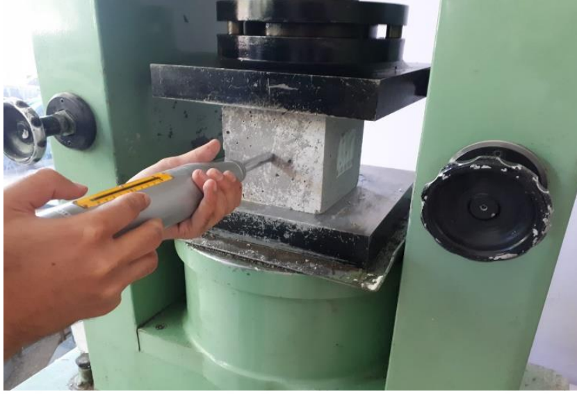
Şekil 3.10. Geri sıçrama deneyinin görüntüsü
