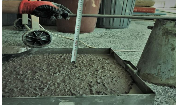
Şekil 3.8. Çökme (slump) deneyi ölçüm anındaki görünüm
