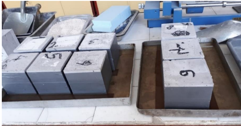
Şekil 3.14. Üretilen betonun kılcallık deneyi görünümü
