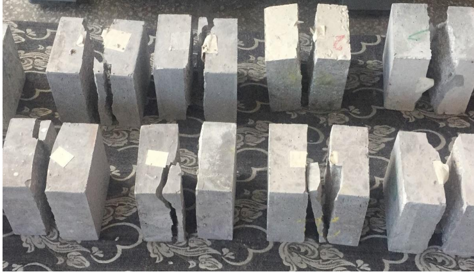
Şekil 3.12. Yarma deneyi (yarmada çekme deneyi) görünüşü
