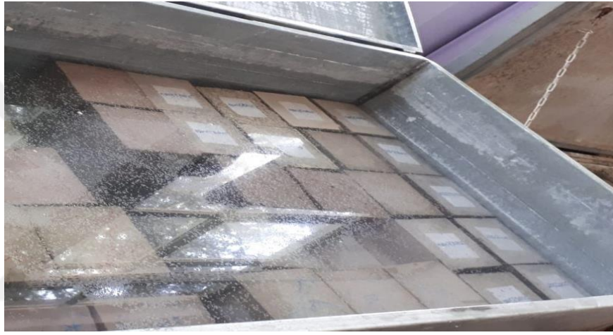
Şekil 3.9. Üretilen betonun kürleme görüntüsü
