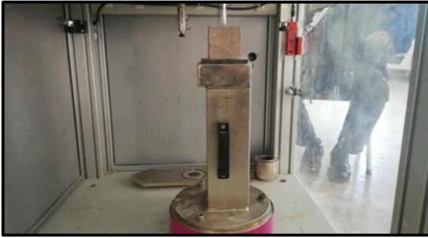
Görsel 7.16 Ağırlık düşürme deney aletiyle numuneye darbe testi uygulaması
