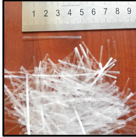
Görsel 7.3 Beton karışımına ilave edilen polyester lifler
