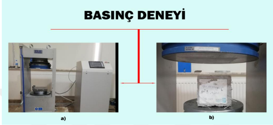
Görsel 7.14 Basınç deneyi a) Deneyde kullanılan basınç test aleti b) Küp numunenin basınç testi
