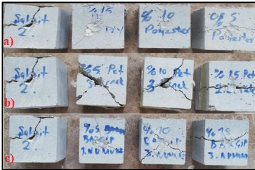
Görsel 7.17 Ağırlık düşürme deneyi sonunda numunelerin görünümü a) şahit-polyester b) şahit-pet c) Şahit- KPF
