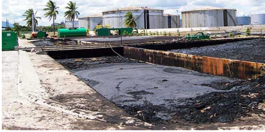
Şekil 3.1. Dinlendirme havuzlarındaki atık petrol çamurları
