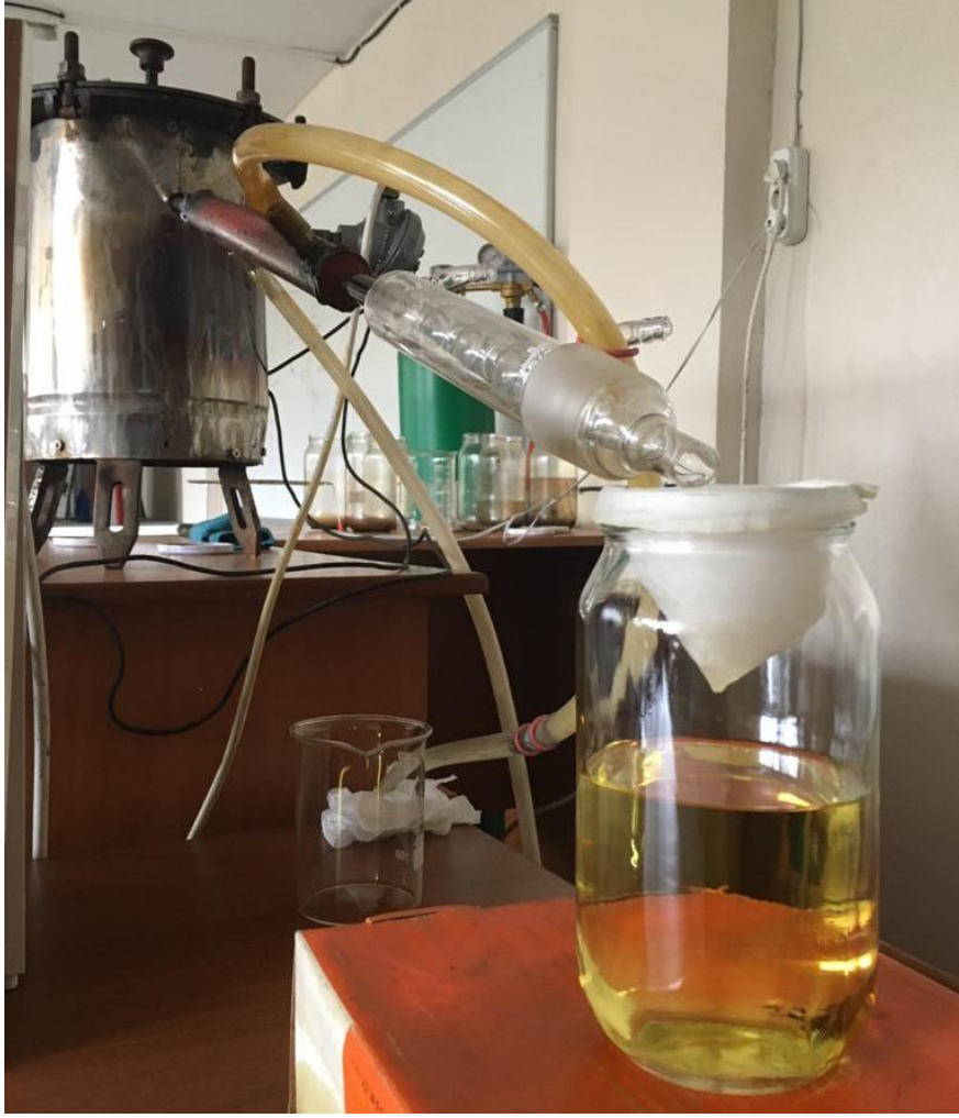
Şekil 7.3. Yakıt üretiminin yapıldığı piroliz düzeneği
