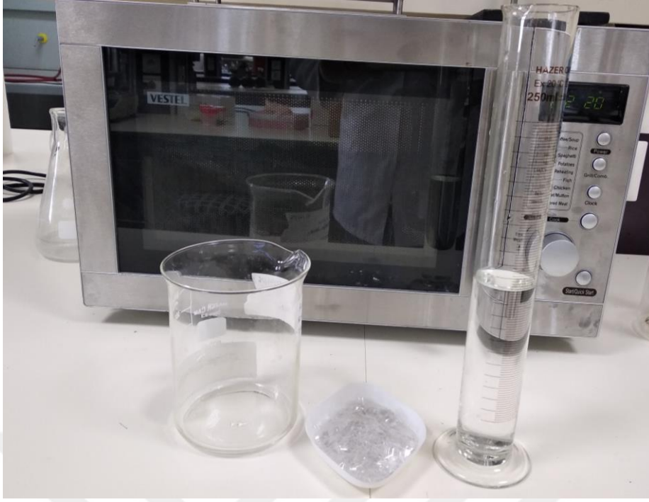
Şekil 3.6 Deneyde kullanılan PET, çözücü ve 500ml beher
