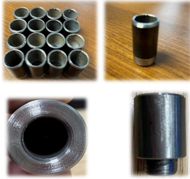
Şekil 4.4. Sıyırılma testi için yapılan kovanlar
