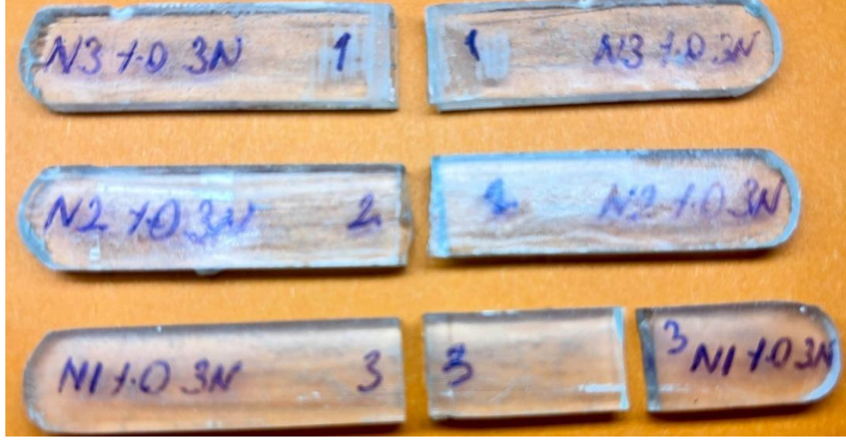
Şekil 5.9 %0 Atık Poliamid Katkılı Numunelerin Görüntüsü
