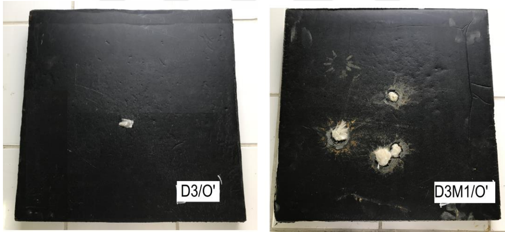
Şekil 3.8: D3/O ve D3M1/O panellerinin atış sonrası arka yüzey görünümü.
