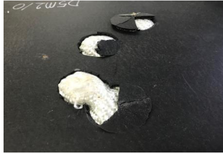
Şekil 3.29: D5M2/O panelinin arka yüzeyinde oluşan deformasyon şekilleri.
