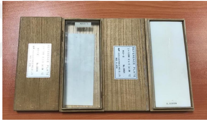
Şekil 2.30: Isı iletimi kalibrasyonunda kullanılan referans plakalar.
