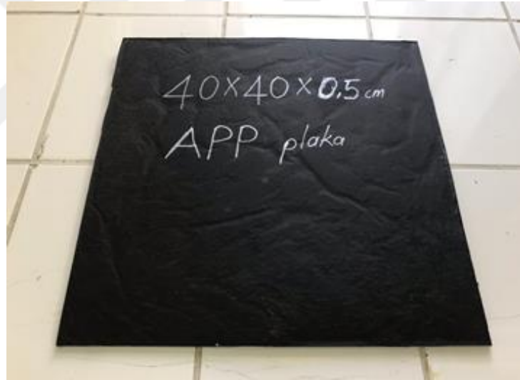
Şekil 2.13: Atık polipropilen (APP) plaka.
