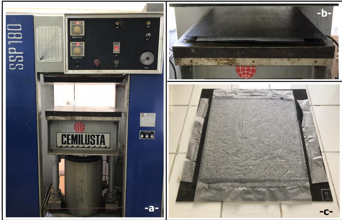
Şekil 2.12: Çalışmada kullanılan hidrolik pres (a), 5 mm’lik APP taslağı (b), soğuk pres sonrası taslağın görünümü (c).
