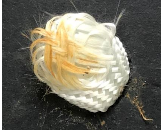
Şekil 3.16: D4M2/O panelindeki dokuma cam lifinde meydana gelen gerilmeler.
