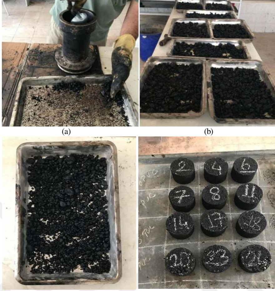
Şekil 3.16. Numunelerin gevşek karışım yöntemiyle üretilmesi ve koşullandırılacak numunelerin belirlenmesi
