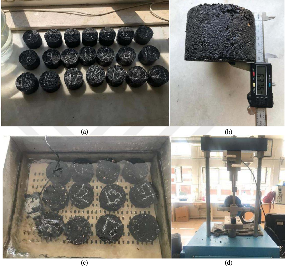
Şekil 3.15. Marshall akma ve stabilite deneyine göre; kırım, tartım ve ölçme işlemleri
