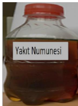
Şekil 3.2. CaO katkı maddesi kullanılarak hazırlanan dizel benzeri yakıt numunesi
