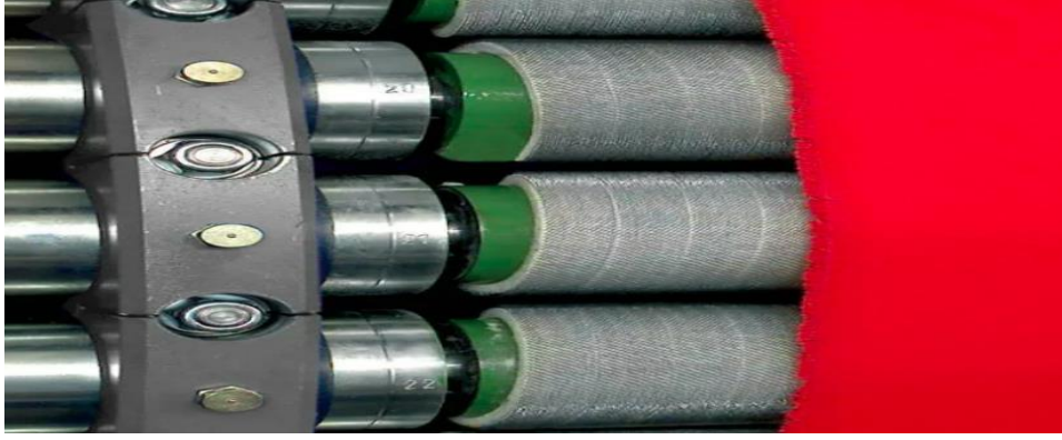
Şekil 3.13: Şardon Makinesi İğneleri (Almaxtex Şirket Bilgileri, 2020).
