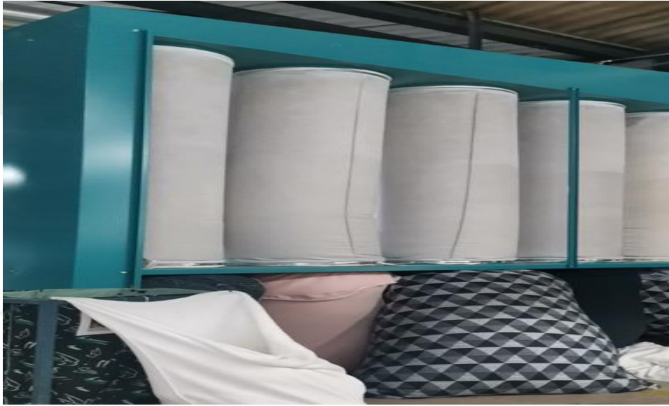
Şekil 3.14: Şardon Makinesinden Çıkan Havların Toplandığı Alan (Almaxtex Şirket Bilgileri, 2020).
