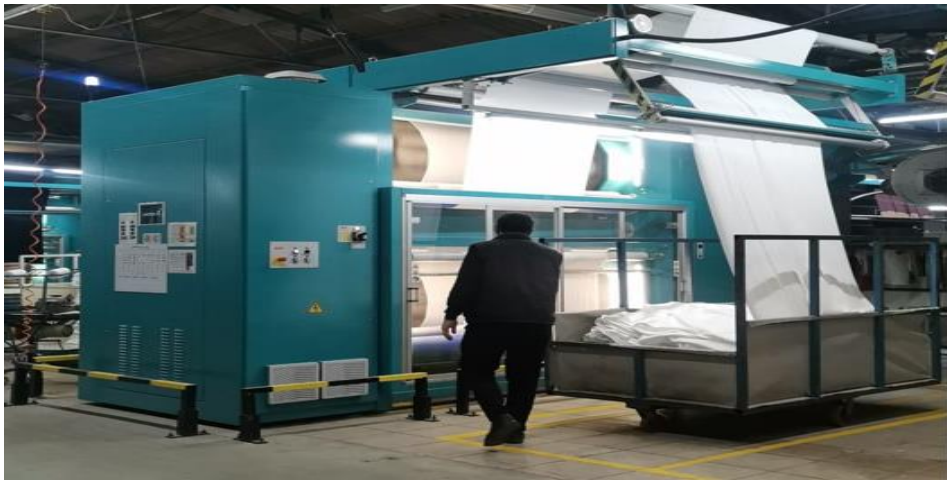
Şekil 3.12: Şardon Makinesi (Almaxtex Şirket Bilgileri, 2020).
