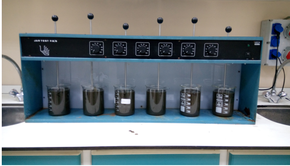
Şekil 3.4. Arıtma çamuru ve küllerin karıştırılması
