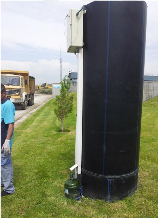
Şekil 2.5. Belediye Atık Su Arıtma Tesisi ön çökeltim ve havalandırma ünitesi
