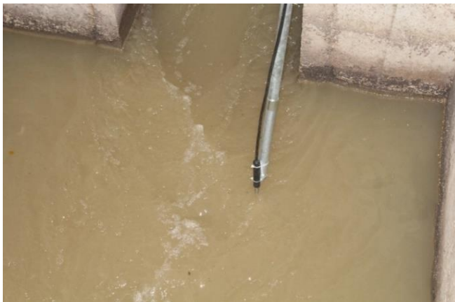
Şekil 36. ADV cihazı ile atık suda hız ölçümü
