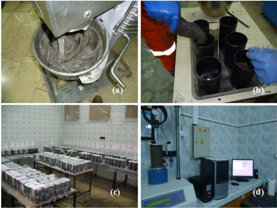
Şekil 26. Macun dolgu numunelerinin hazırlanması ve testi: karıştırma (a), döküm işlemi (b), kür alma (c) ve dayanım testi (d)
