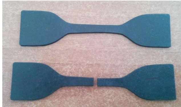
Şekil 7.7: Çekme testi numunesinin deney öncesi ve deney sonrası görünüşü.
