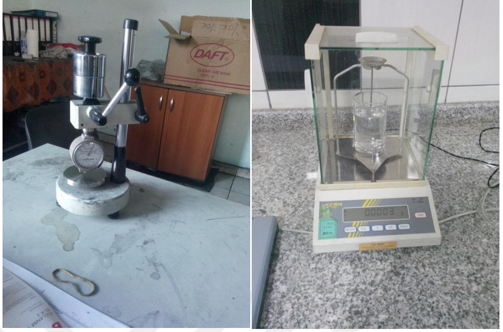
Şekil 7.5: Sertlik ölçme ve yoğunluk ölçme cihazları.
