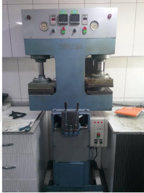
Şekil 7.4: Test plakası basma presi.
