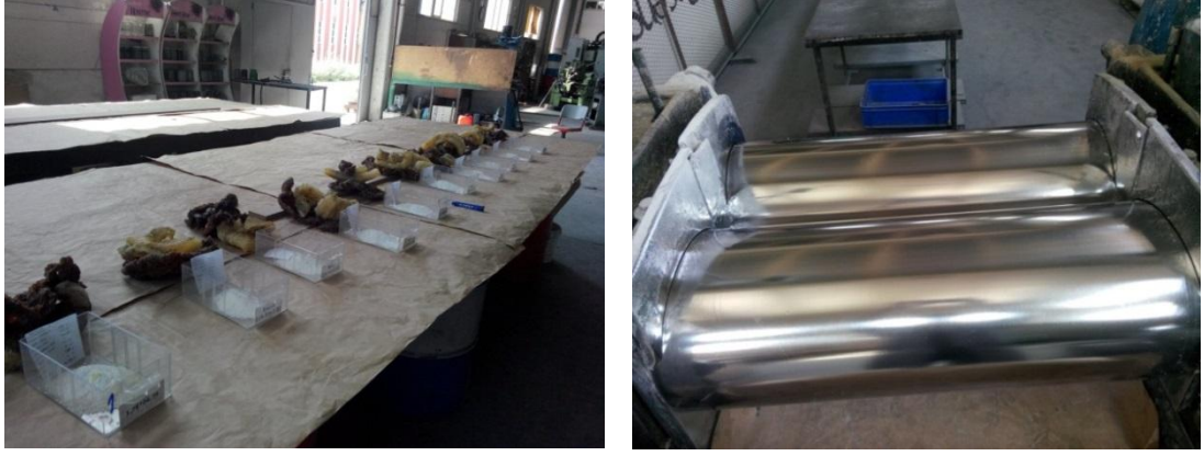
Şekil 7.1: Kauçuk hamurunun hazırlanması.
