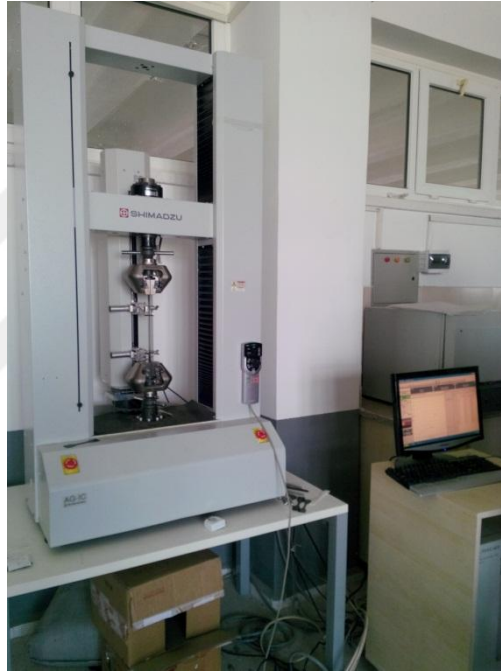
Şekil 7.6: Çekme test cihazı.
