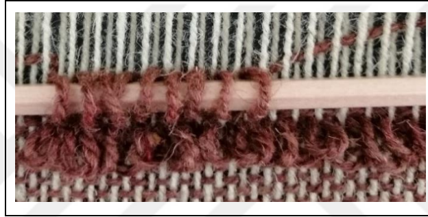
Resim 19. Çubuğa sarılarak yüzeye çekilen atkı iplikleri 65
