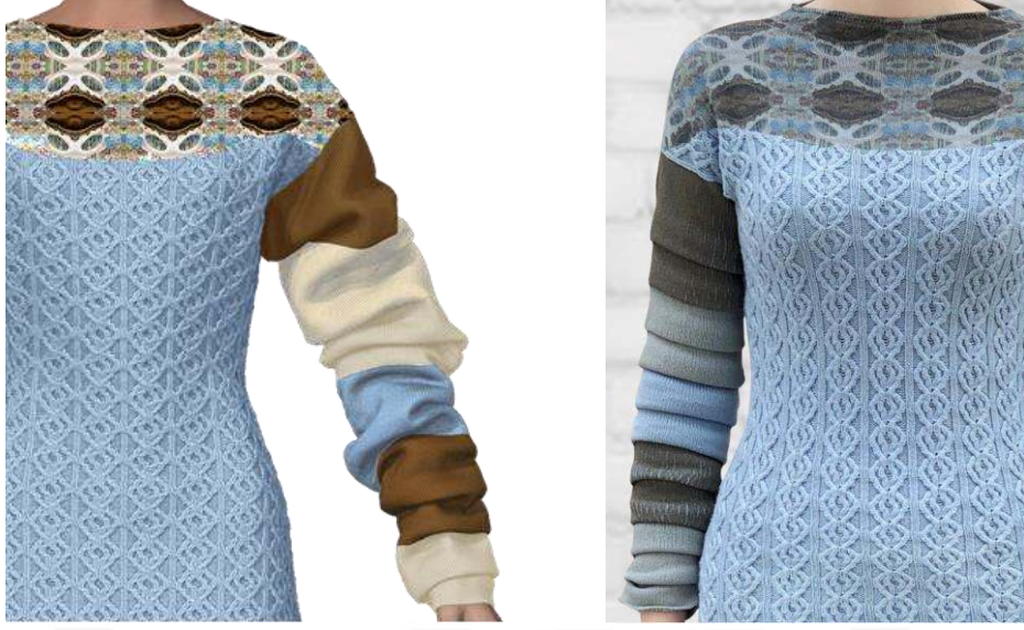
Görsel 9.17. “Tasarım 2” üç boyutlu simülasyon ve üretim sonucunun örgü, baskı deseni karşılaştırması
