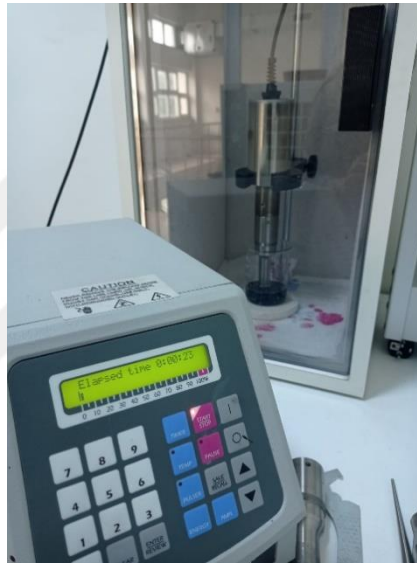
Şekil 5. 3. CNT/PVA Çözeltisine Uygulanan Sonikasyon İşlemi
