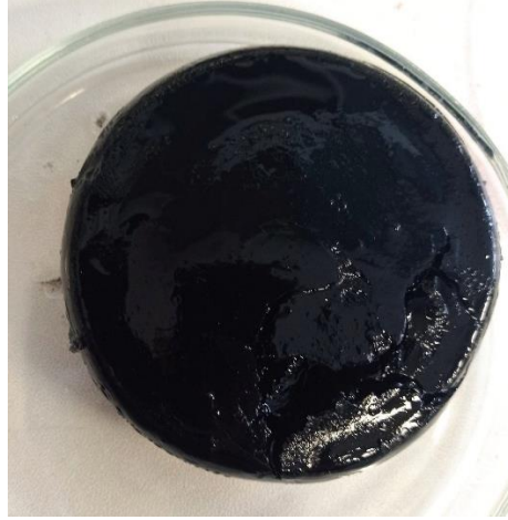
Şekil 5. 4. Üretilen CNT/PVA Kompozit Malzemesi
