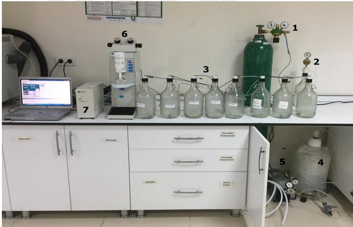
Şekil 3.8. OKFE Cihaz ve Ekipmanları: 1-Taşıyıcı gaz (yüksek saflıkta azot gazı), 2-Atık solvent şişesi, 3- Solvent şişeleri, 4- Atık bidonu, 5- Vakum pompası, 6- Ekstraksiyon ünitesi, 7- OKSFE cihazı kontrol ünitesi
