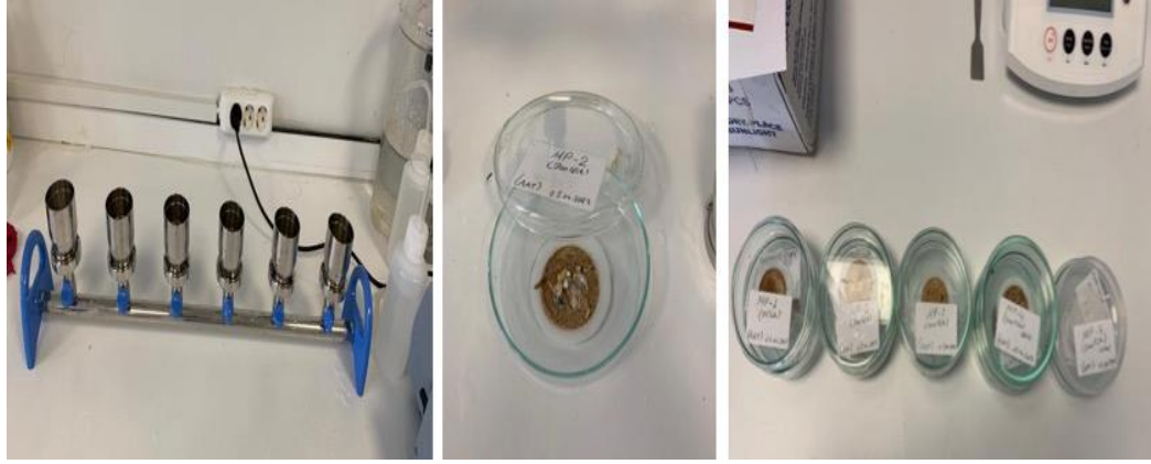
Şekil 3.26. Vakumlu filtrasyon sistemi.
