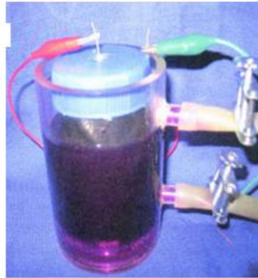
Şekil 2.17. İki Bölmeli Tek Tip MYH reaktörü (You ve diğ., 2006).
