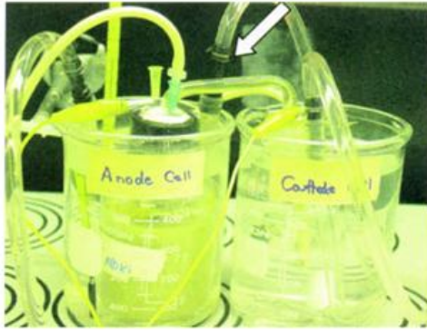
Şekil 2.13. (a) Tuzlu köprü-tip MYH (Min ve diğ., 2005), (b) U şeklinde iki-bölmeli MYH dizaynı (Milliken ve May, 2007).
