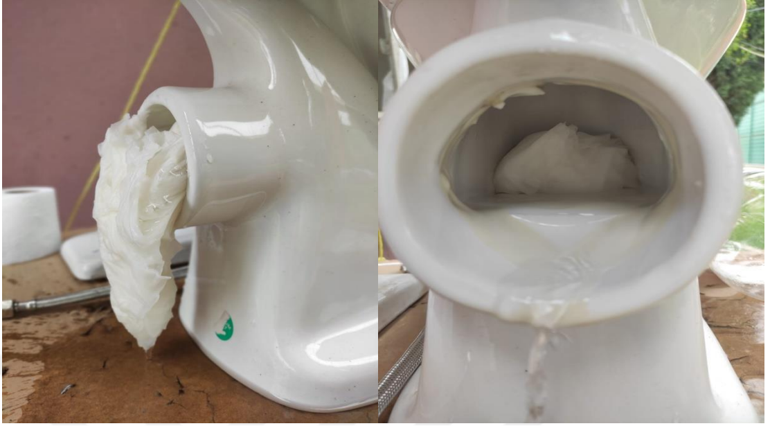
Şekil 4.29. Pissu boru hattına ulaşamadan tıkanma gerçekleştiren tuvalet kağıtları
