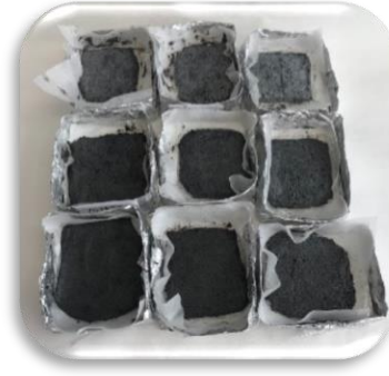
Şekil 6.4. Arıtma çamurunun kürlenme süreci
