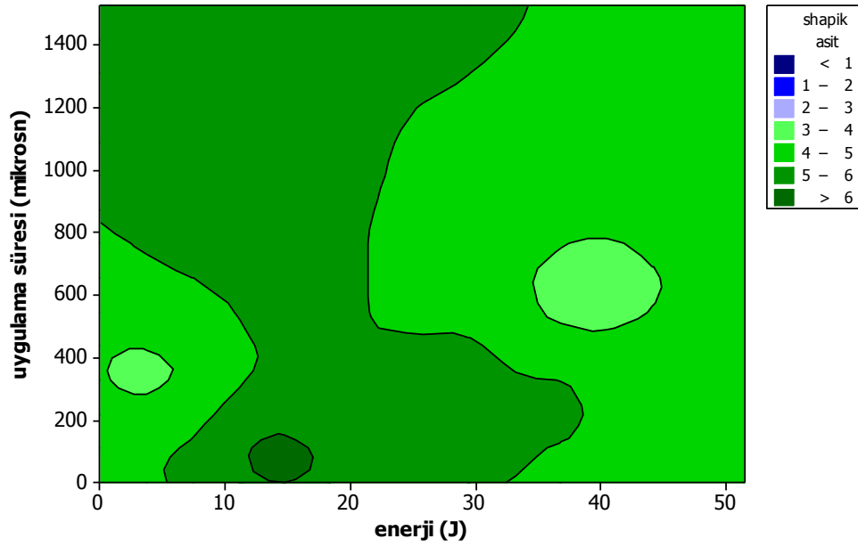
Şekil 4.33. Atımlı elektrik alanı ile proses edilen nar sularında uygulama süresi ve enerji seviyesinin fonksiyonu olarak shapik asit (mg/L) miktarındaki değişim.
