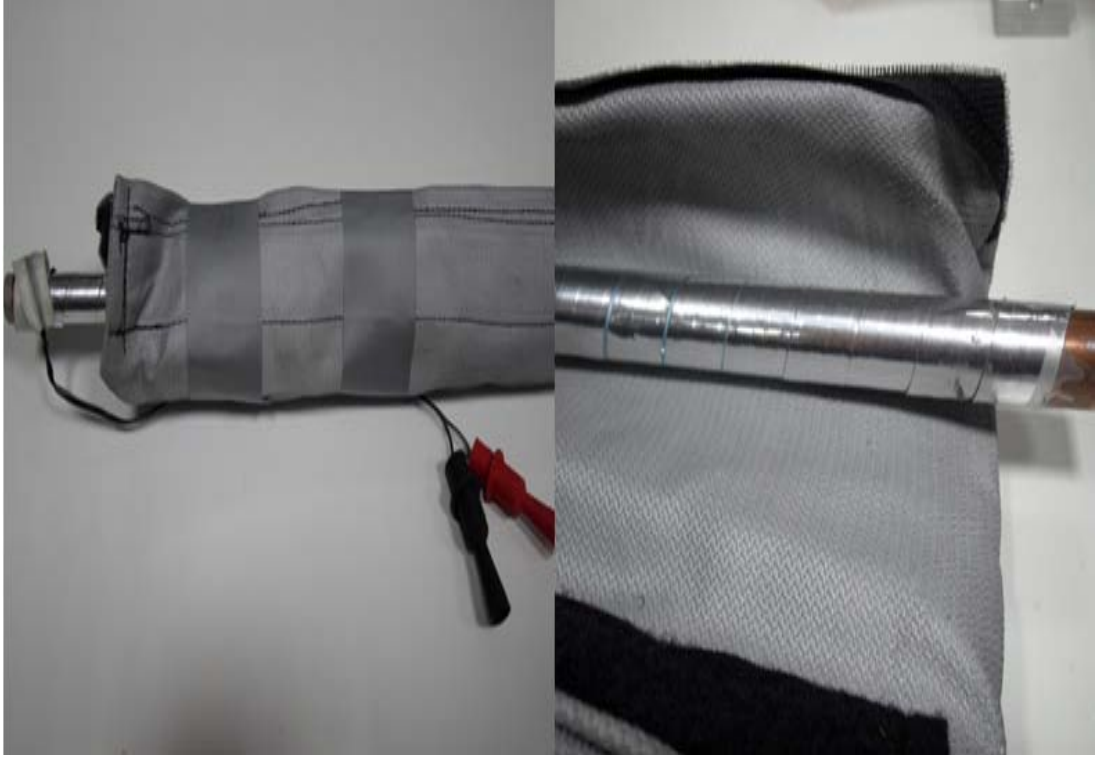
Şekil 3.7. Test bölgesi (bakır boru, yaprak ısıtıcı ve izolasyon)
