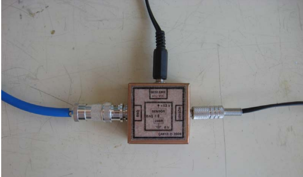
Şekil 3.15. Sinyal dönüştürücü devre ve Faraday kafesi
