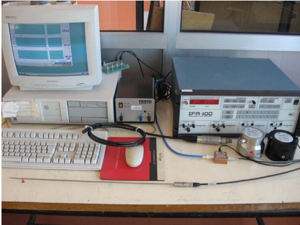
Ek Şekil 3. IFA100 Sıcak tel sabit sıcaklık anemometresi ve basınçölçerler
