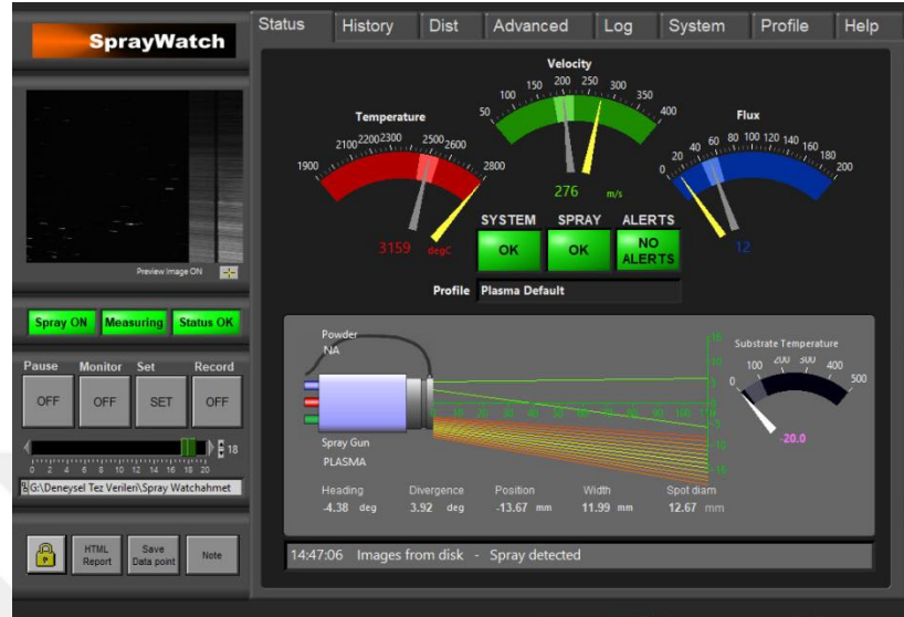
Şekil 6.9. Spray Watch sistemi kaplama esnasındaki partikül özellikleri.
