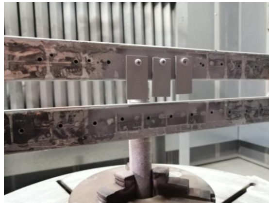
Şekil 6.7. Kumlama sonrası döner tablaya sabitlenmiş numuneler.
