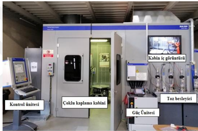
Şekil 6.8. Sulzer Metco çoklu kaplama kabini ve bileşenleri.
