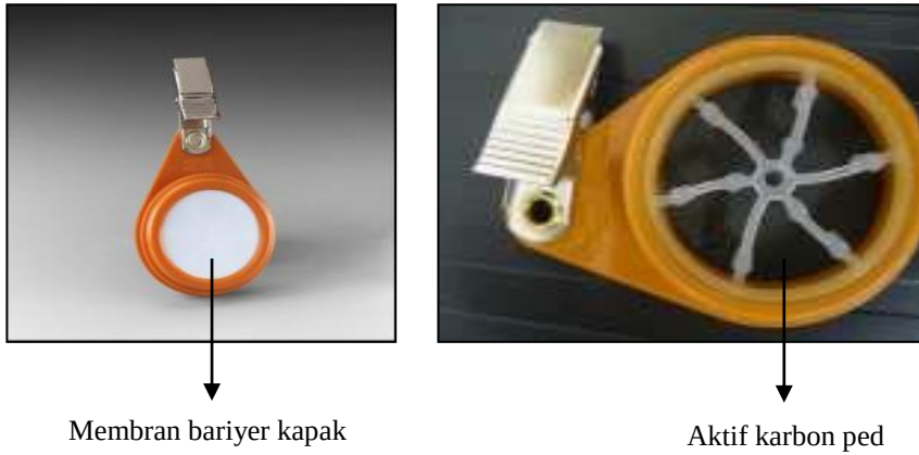
Şekil 4.12. 3M OVM 3500 pasif örnekleyici
