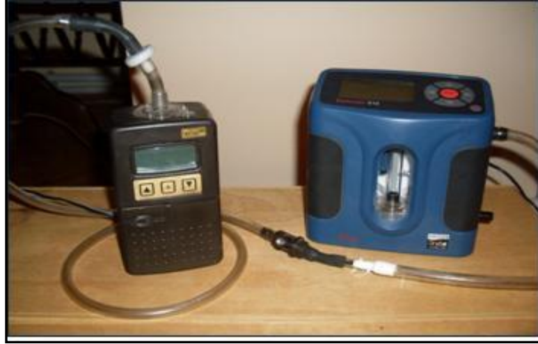
Şekil 4.16. SKC aktif örnekleme pompası çekiş hızının ayarlanmasında kullanılan Defender 510 kalibratör
