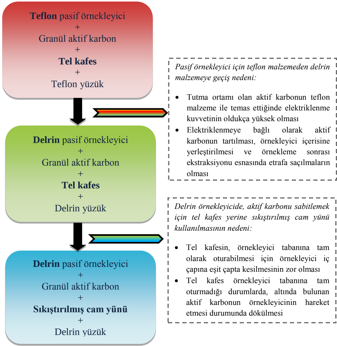
Şekil 4.4. Tez çalışması süresince oluşturulan pasif örnekleyici modifikasyonları
