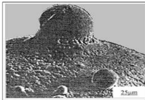
Şekil 3.7 Bir toz yüzeyindeki uydu tozları (Küçükarslan,2006)
