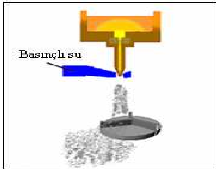
Şekil 1.10 Döner disk atomizasyon yöntemi(Küçükarslan,2006)
