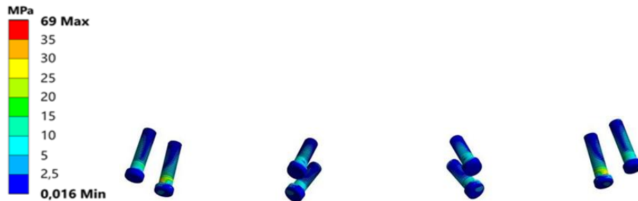
Şekil 4.18. Ti-Porselen protez tasarımında fiksasyon vidası üzerinde oluşan von Mises stres değerleri
