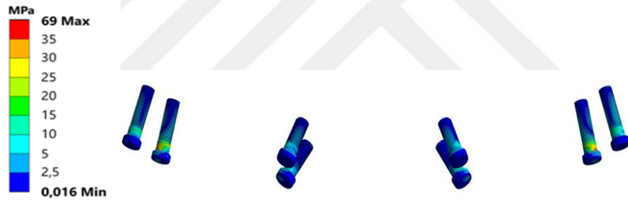
Şekil 4.17. Ti-Akrilik rezin protez tasarımında fiksasyon vidası üzerinde oluşan von Mises stres değerleri
