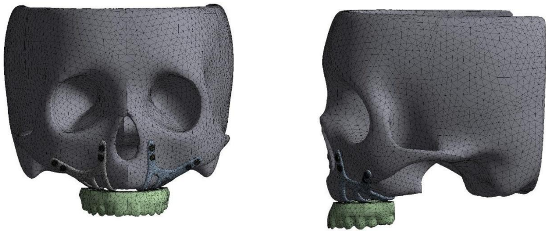
Şekil 3.5. Modelin mesh yapısının görüntüsü
