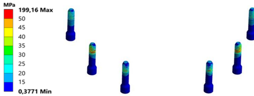
Şekil 4.29. Zr-Porselen protez tasarımında protez vidası üzerinde oluşan von Mises stres değerleri
