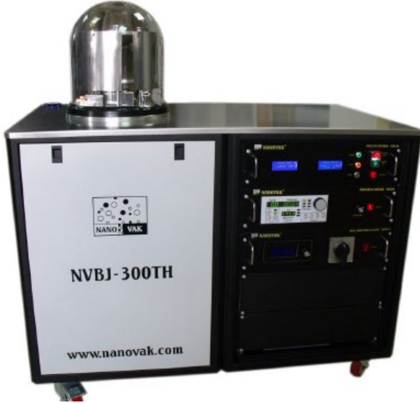
Şekil 3.6. Fiziksel Buhar Biriktirme Cihaz Gösterimi
