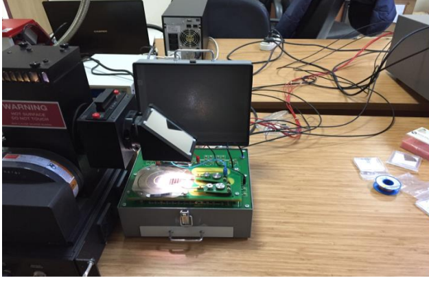
Şekil 3.11. Akım-voltaj ölçümleri için kullanılan deney düzenekleri:a) Güneş similatörü b) I-V ölçüm sistemi
