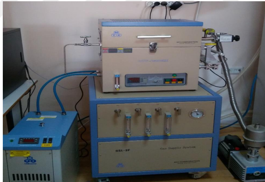
řekil 3.3. OTF-1200X tavlama yapılan fırın
