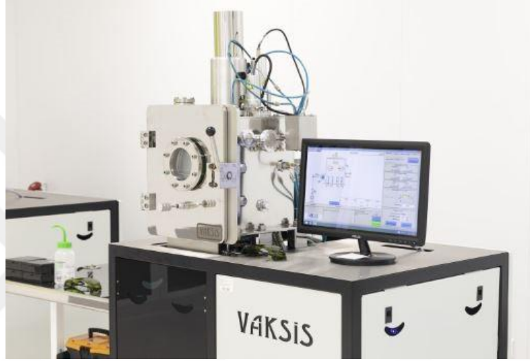
Şekil 3.1. VAKSIS Pvd termal buharlaştırma cihazı
