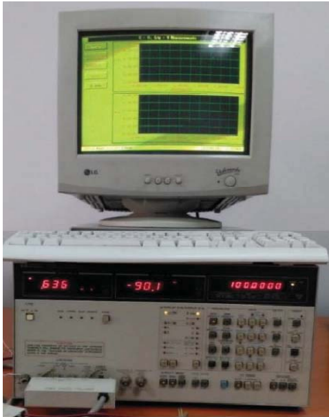
Resim 3.1. HP 4192 LF empedans analizörü ve IEEE-488 AC/DC dönüştürücü takılı bilgisayar.
