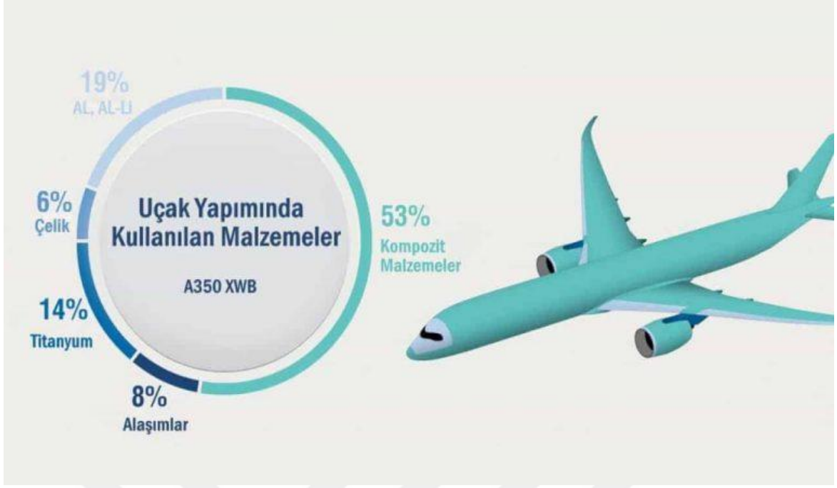
Şekil 1.6 Airbus A350 XWB yapımında kullanılan malzemeler[30]
