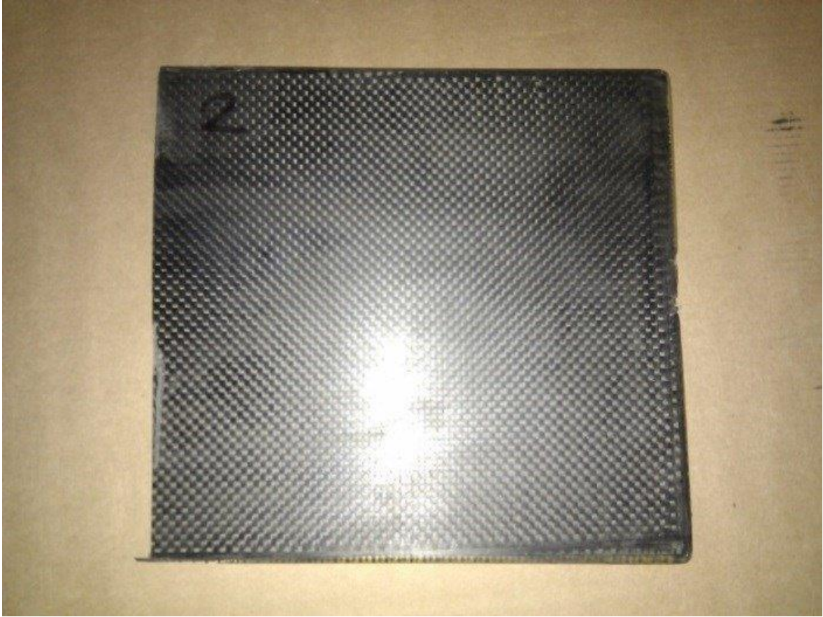
Şekil 1.9 Epoksi reçinesine daldırılmış bir karbon fiber örneği[35]
