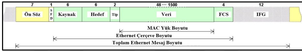
Şekil 4.9. AFDX paket yapısı [23]
