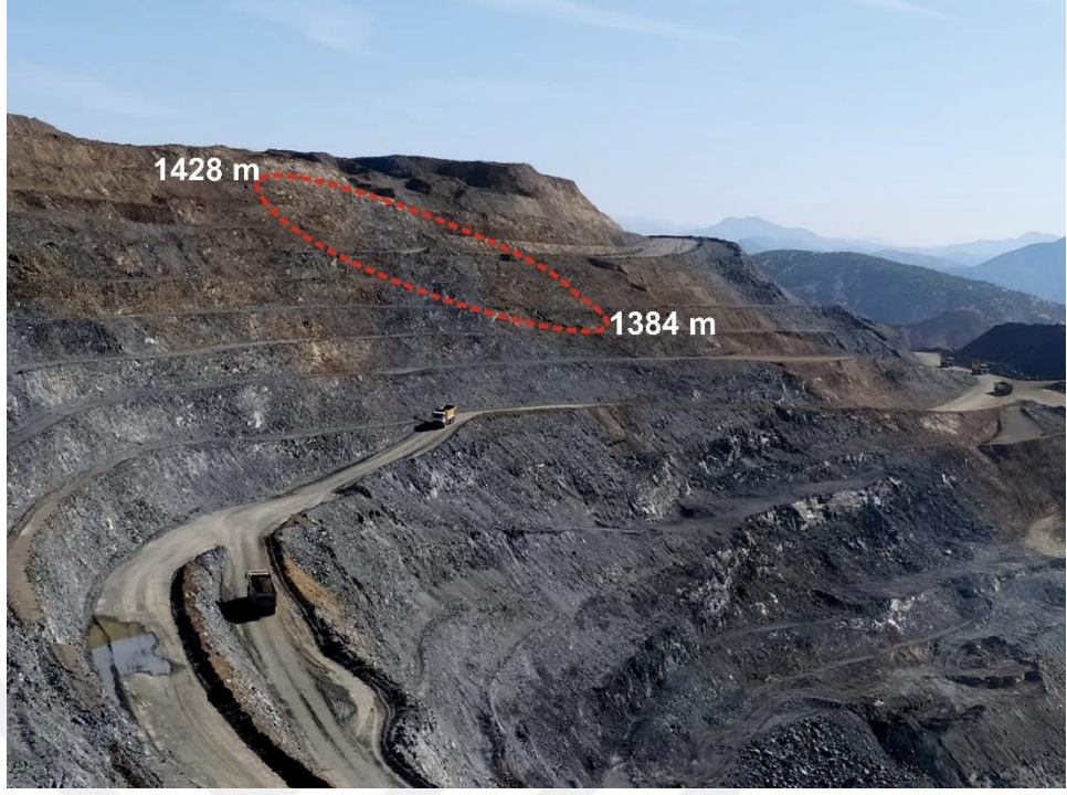
Şekil 3.21 S1’de meydana gelen kayma
