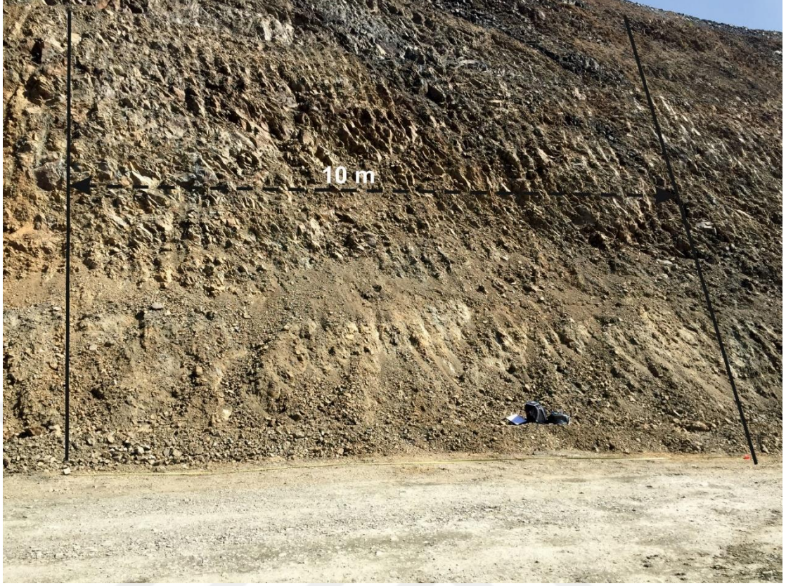
Şekil 3.10 Çalışma sahasında mostra yüzeyinde yapılan süreksizlik hat etüdü
