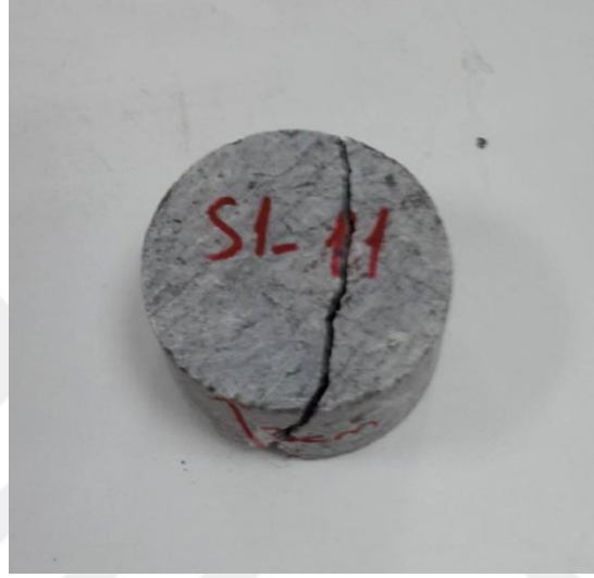
Şekil 3.13 Dolaylı çekme dayanımı için kullanılan numune (fillit)
