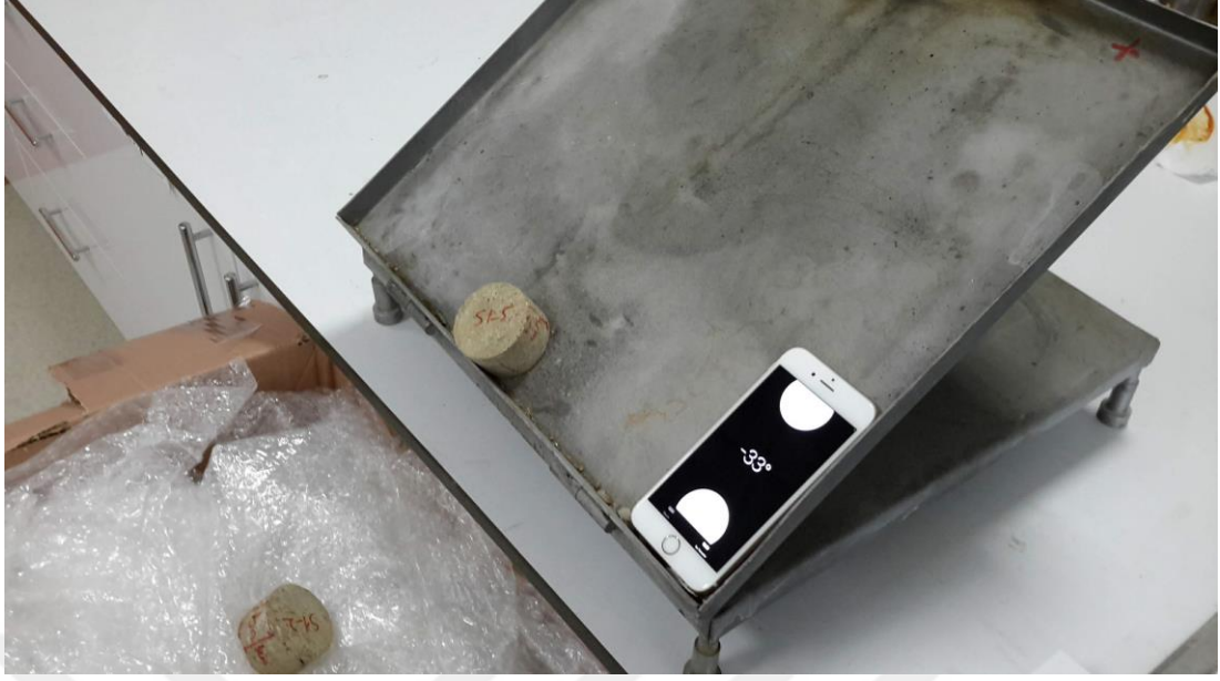
Şekil 3.16 Tilt deneyinde temel sürtünme açısı belirlenen numune (mikaşist)
