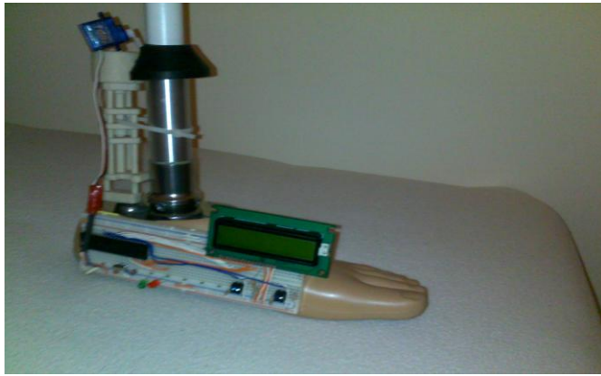
Şekil 5.17 Kontrol devresi monte edilmiş protezin son görüntüsü-2
