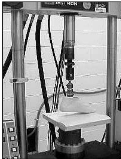
Şekil 3.4 Ayak bileği protezine rijitlik testi uygulanması, ( http://www.oandp.org )
