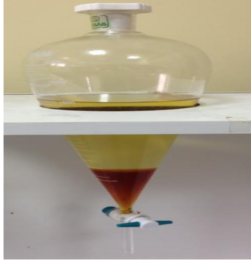
Şekil 8.3. Biyodizel içerisindeki gliserinin çökmüş hali.
