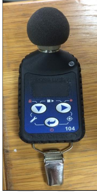
Şekil 8.11. Svantek 104 model bir gürültü ölçüm cihazı (dozimetre).
