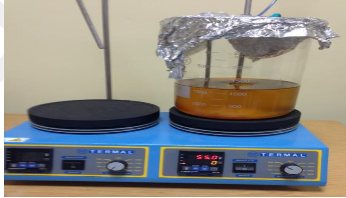
Şekil 8.2. Biyodizel üretimi (esterleştirme reaksiyonu).
